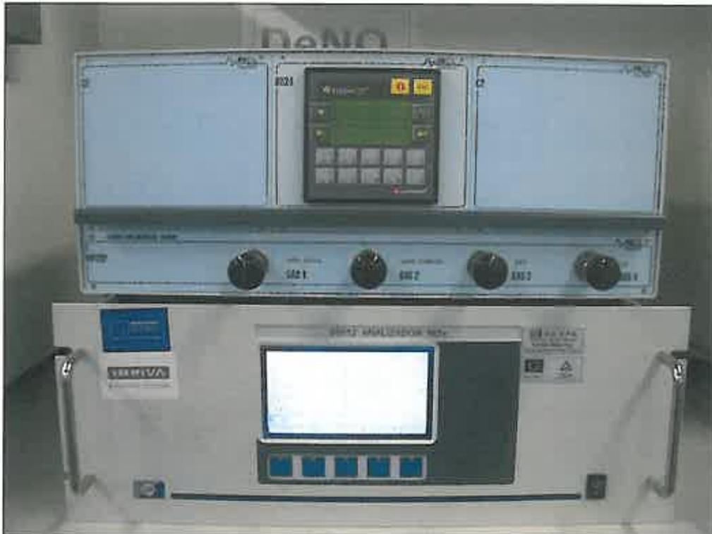
Figura 5.- Imagen del mezclador de gases que contiene los controladores de flujo másico y del detector de óxidos de nitrógeno.
