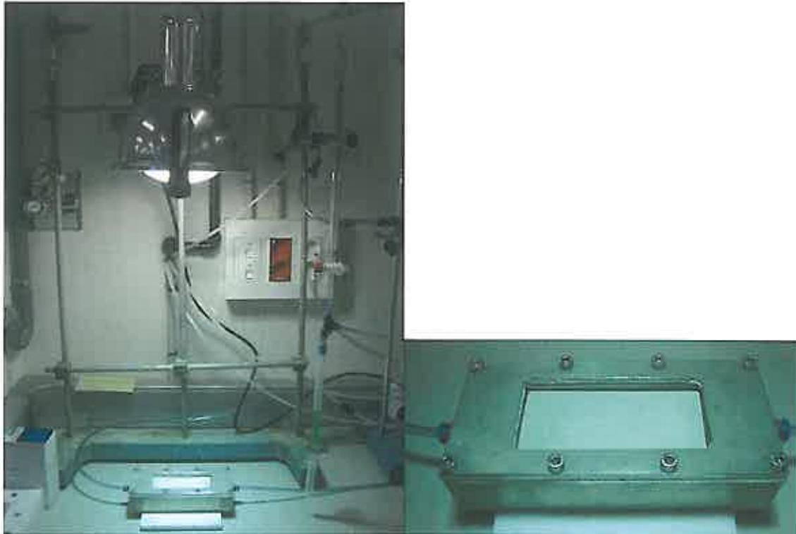
Figura 4.- Izquierda, lámpara OSRAM Vitalux y fotoreactor. Derecha, detalle del fotoreactor.
